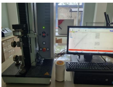
Gambar 3. Instron Strength Tester Untuk Menguji Kekuatan Tarik dan Mulur Benang
