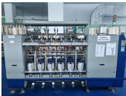
Gambar 2. Mesin TFO Untuk Proses Pemberian Twist Pada Benang
