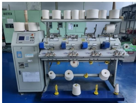
Gambar 1. Mesin Doubling Untuk Proses Perangkapan Benang
